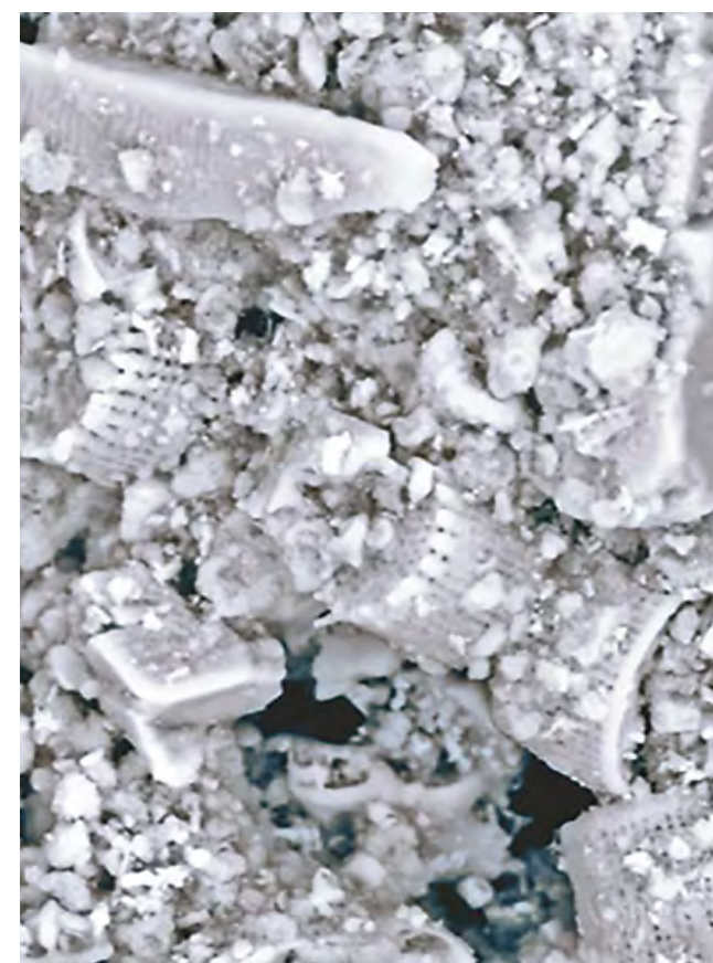
Na mikroskopickom zobrazení povrchu omietky vidno, ako sa voda rýchlo rozptyľuje a schne.
