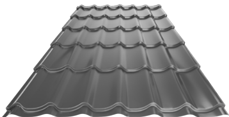
DX51D EN 10346 Z 140 g/m 2 ZM PE25μ/PE7μ, Lesk 30% Polyester
